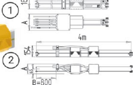
Prémontée sur 1m ou 4m de gaine - Poids maxi 130A = 15 kg - 160A = 20 kg - 200A = 23 kg (y compris câble de raccordement de 2 m). Prévoir un boîtier de raccordement déporté.
