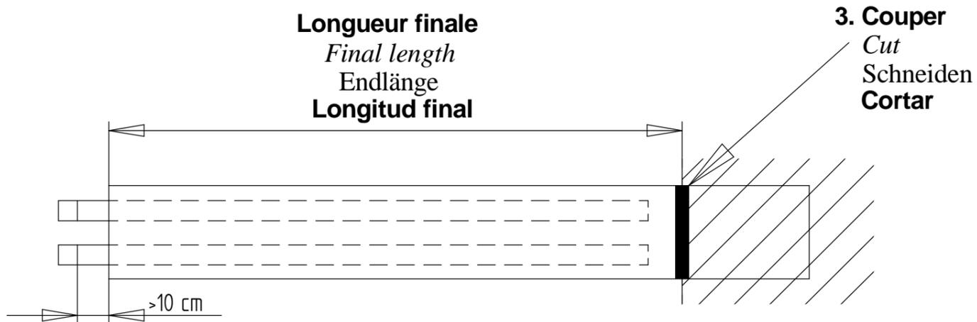
**4. Réaliser, au niveau de la coupure, des encoches afin de reconstituer les distances d'isolement**
