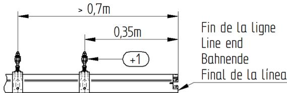
**Fin de ligne :** si la distance avec la dernière suspension > 0,7m, rajouter une suspension supplémentaire à 350 mm de l'extrémité
